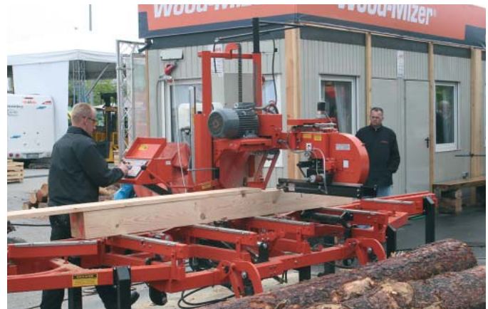
Mobile LT XX wurde mit einem verbesserten Sägekopf ausgestattet und der Blattführungsarm ist hydraulisch gesteuert
