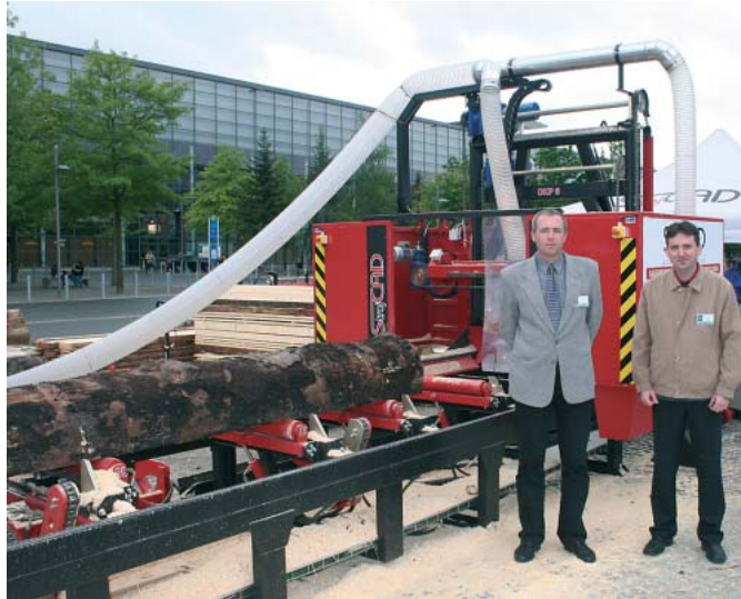
XXXXXXX XXX und DI Jozef Plagany präsentieren die DKP 6, eine Zweiblatt-Kreissäge für exakten Schnitt von Stämmen bis 100 cm
