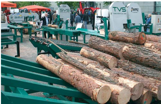
Das neue Woodmizer-Schmalbandsystem für kurze Stämme ermöglicht wirtschaftliche Nutzung von zuvor unrentablen Stämmen
