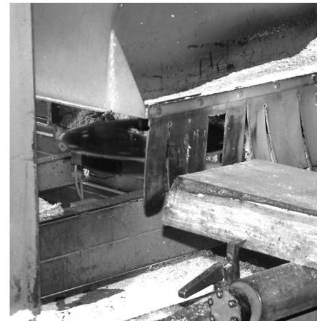
Kreissäge-Blatt kann um 90° gekippt werden
