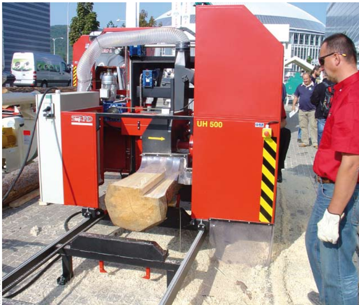
Pilarka tarczowa z wychylną piłą może służyć do wycinania z kłody gotowych elementów.
